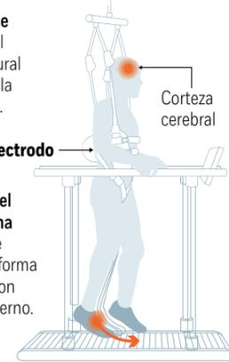
El implante, del tamaño de una batería AA, se comunica de forma inalámbrica con un control externo.
